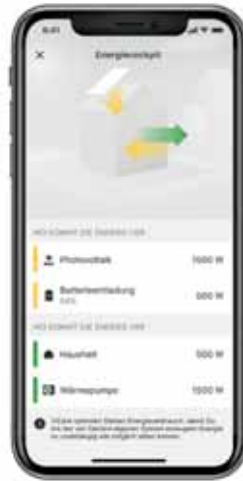
Auf dem Energie-Cockpit der ViCare App hat der User die Energieflüsse seines Haushalts im Blick.
